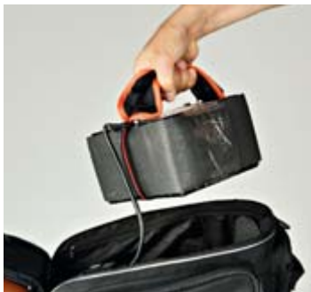
E-SPIN-JÄRJESTELMÄ saa tällä hetkellä energiansa kahdesta saraan kytketystä lyijyakusta. Viisikiloisen paketin voi ottaa vaikka työpöydälle latautumaan.
