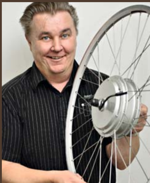
MIKKO Torvinen asentaa E-spinin moottorin etupyörän napaan. Järjestelmä ei säätelä moottorin tehoa lainkaan, mutta silti sähkövoima yhdistyy lihasvoimaan pehmeästi ja sulavasti.
