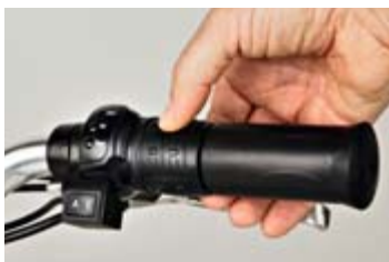
FRISBEEN valintakytkimen asento A tekee pyörästä automaattisen, eli moottori toimii elektroniikan ohjaamana. E (economy) antaa käyttäjän valita haluamansa sähkömärrän kaasukahvasta vääntäen.
