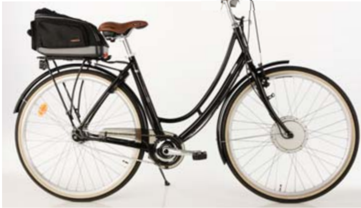
HELKAMAN Saana-malliin asennettu E-spin tuo lisäpainoa 11 kiloa, mutta järjestelmä nivoutuu pyörään varsin huomaamattomasti. Äänettömyys madaltaa profiilia entisestään.
